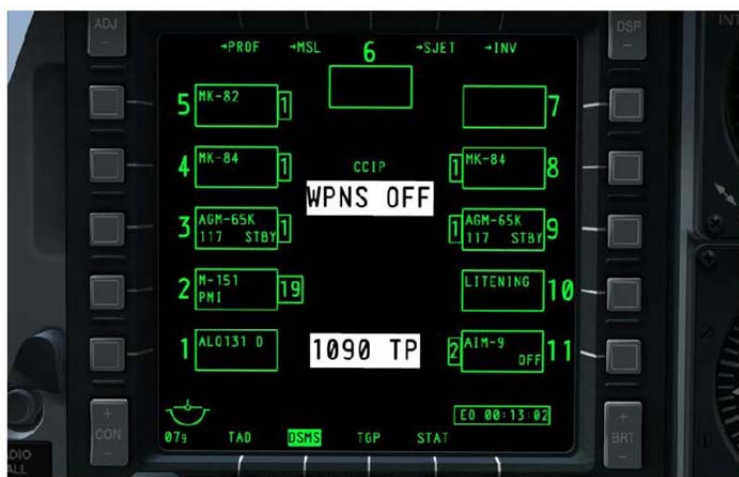
图210 武器关闭，主武器电门置于SAFE端
