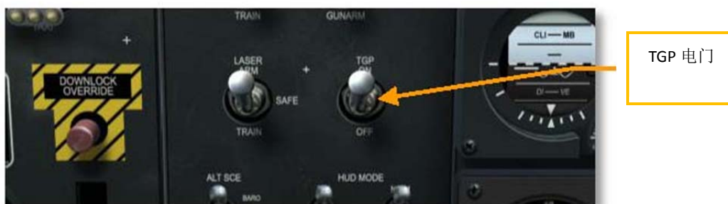
图 329 将 AHCP 上 TGP 电门置于 ON 位置
