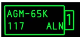
图 456.小牛挂点，校准中
