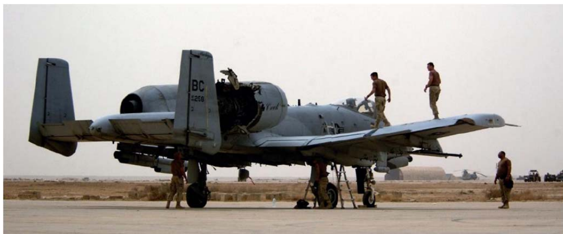
图-29.机务人员正在检查一架被伊拉克导弹击伤的A-10
