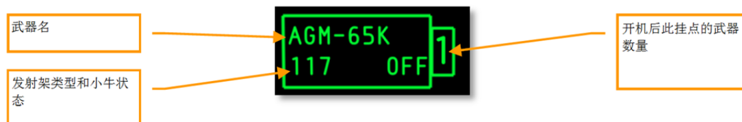
图 455.小牛挂点，断电
