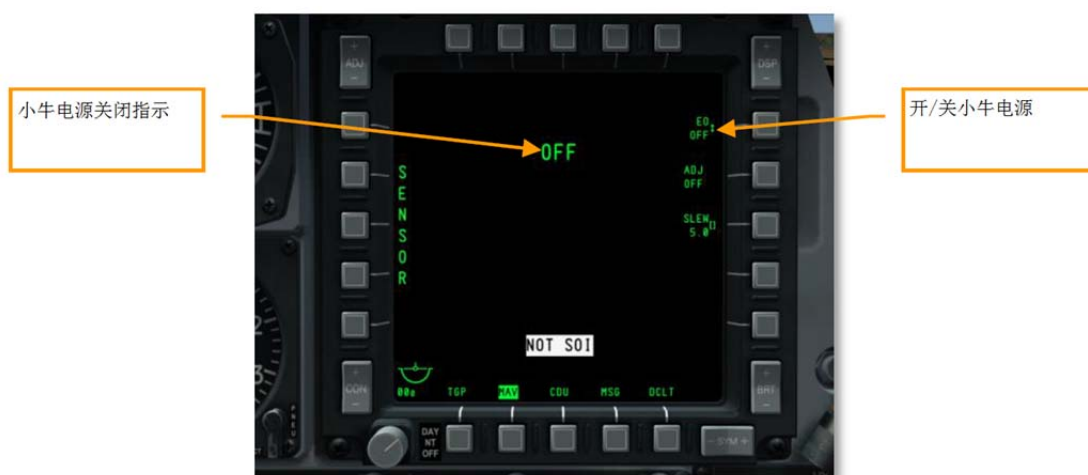
图 453.DSMS 小牛页面，光电开关为 OFF
