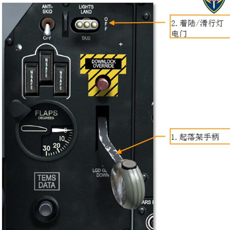
图300 起落架及襟翼面板
