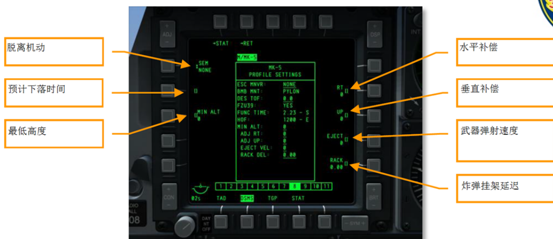
图 411. DSMS配置文件设置页面, 火箭弹配置文件
