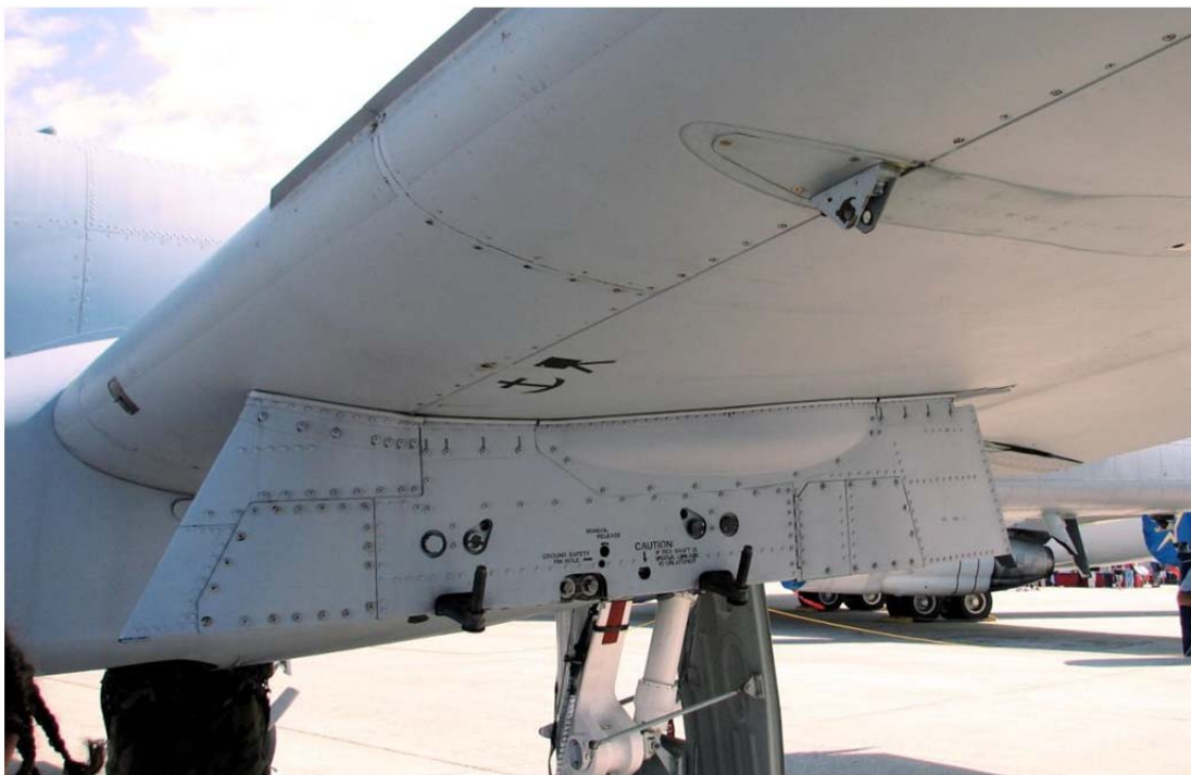
图 42 单弹射挂架挂在武器挂点上
