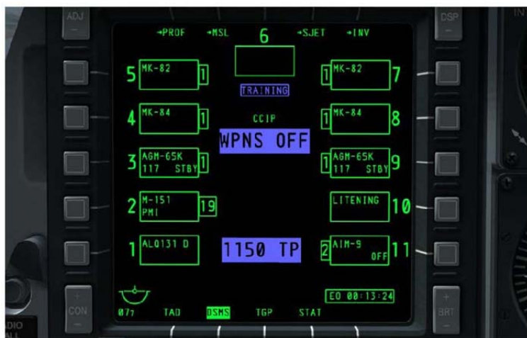
图211 武器关闭，主武器电门置于Training端
