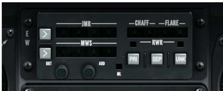
图.87 反制设备控制面板
