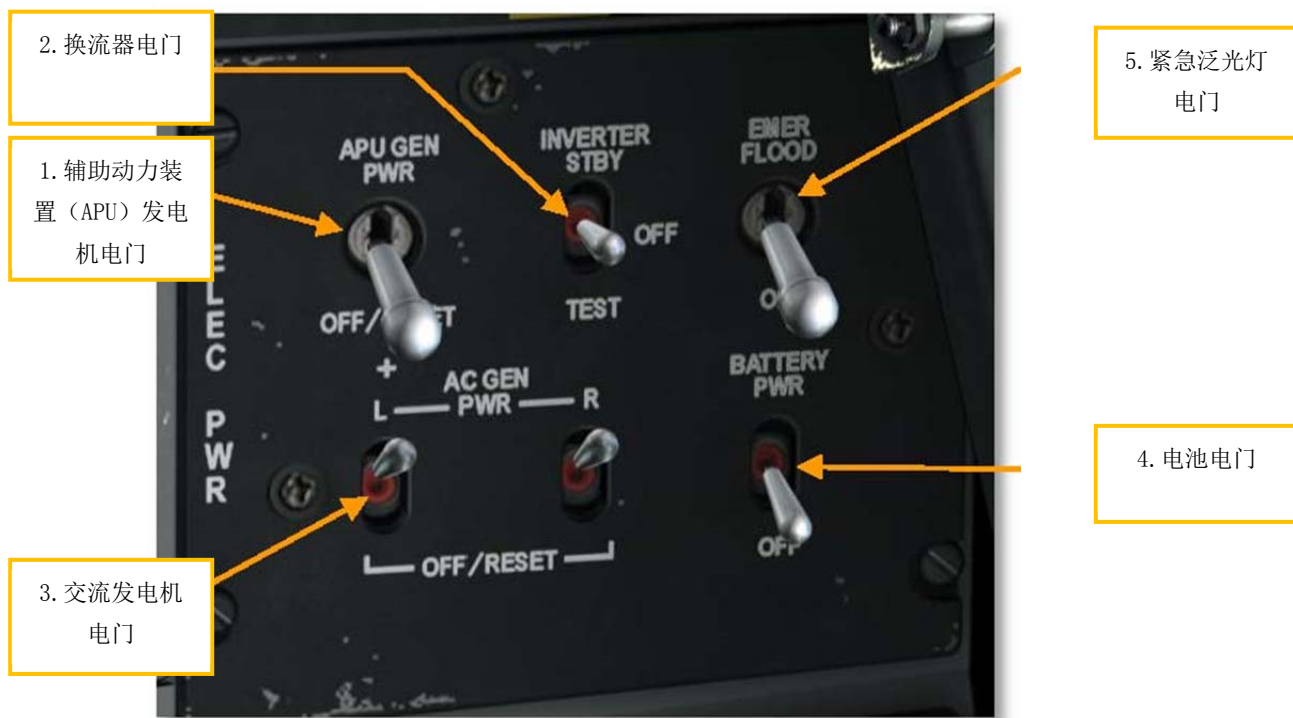
图303 电力控制面板
