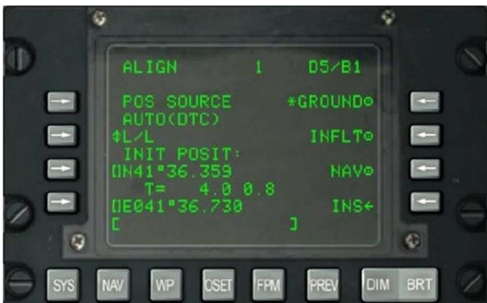
图 145. System-INS-ALIGN Sub-Page
