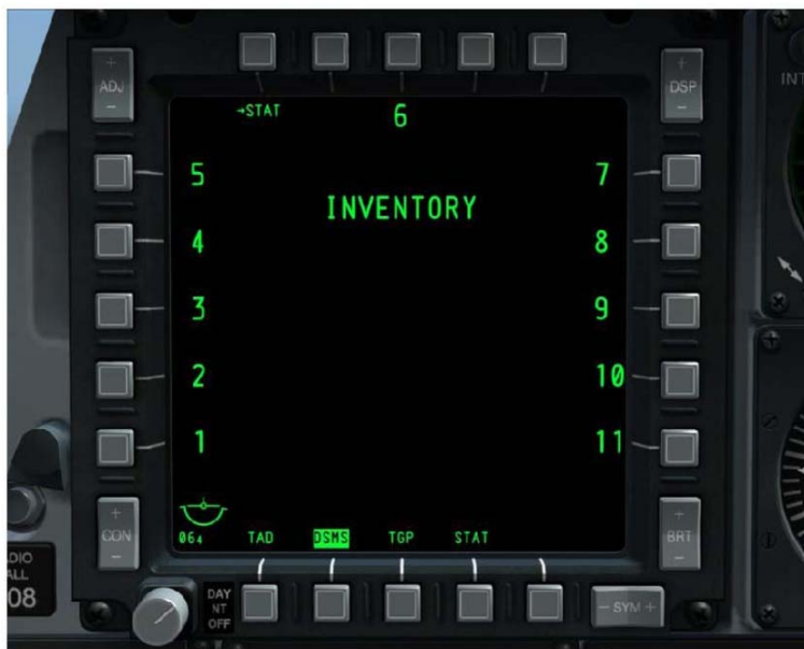
图220 DSMS挂载储量页面——无挂载
