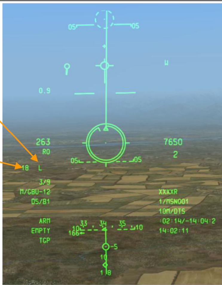
图 455.激光制导炸弹 CCRP 轰炸模式下的 HUD，炸弹投放后。
