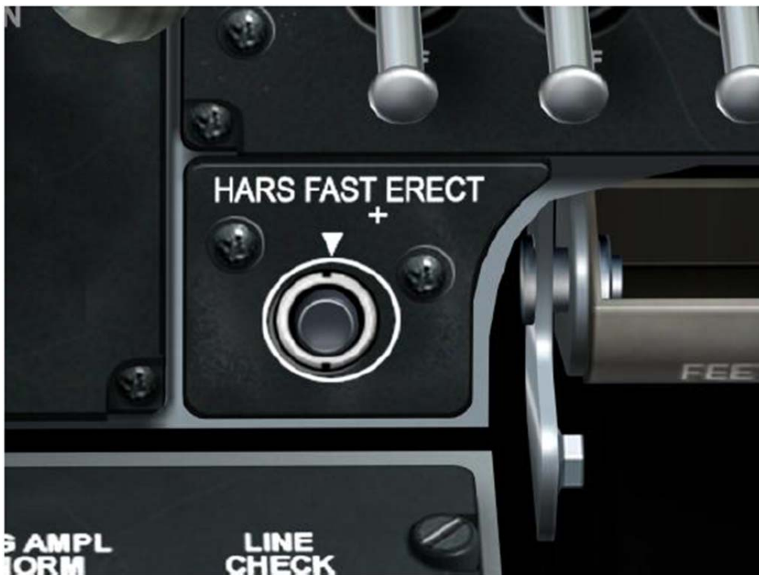
图-83. HARS 快速归零按钮
