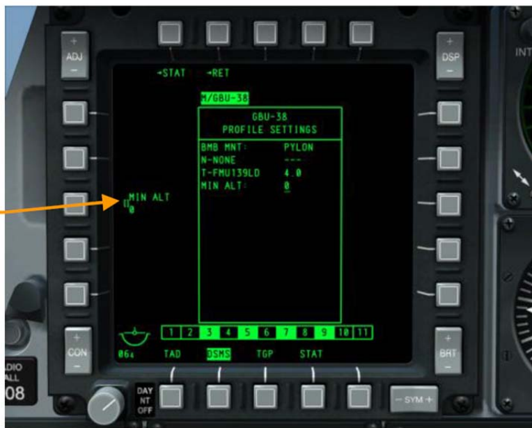
图 451.DSMS 设置页面，惯性制导武器
