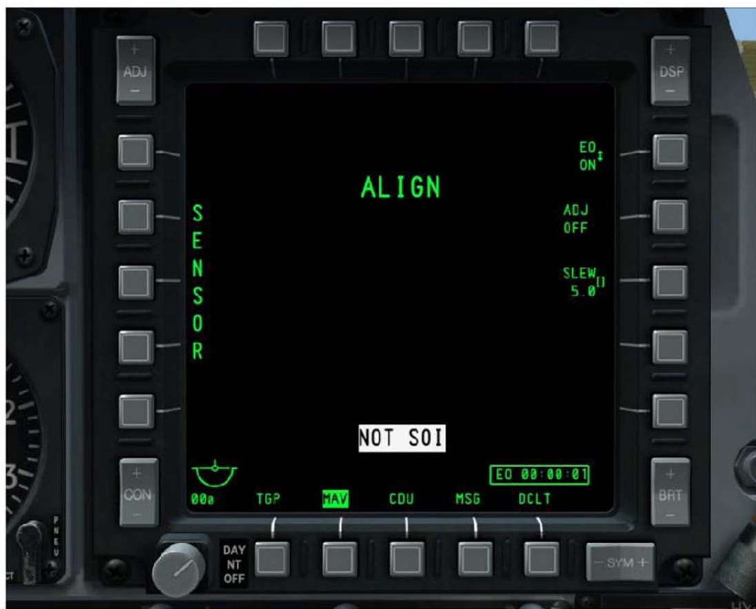
图 257 小牛导弹校准页面
