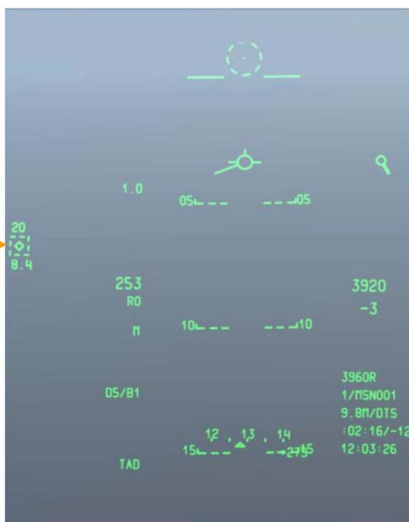
图 394. TGP菱形框作为SPI时HUD的导航显示
