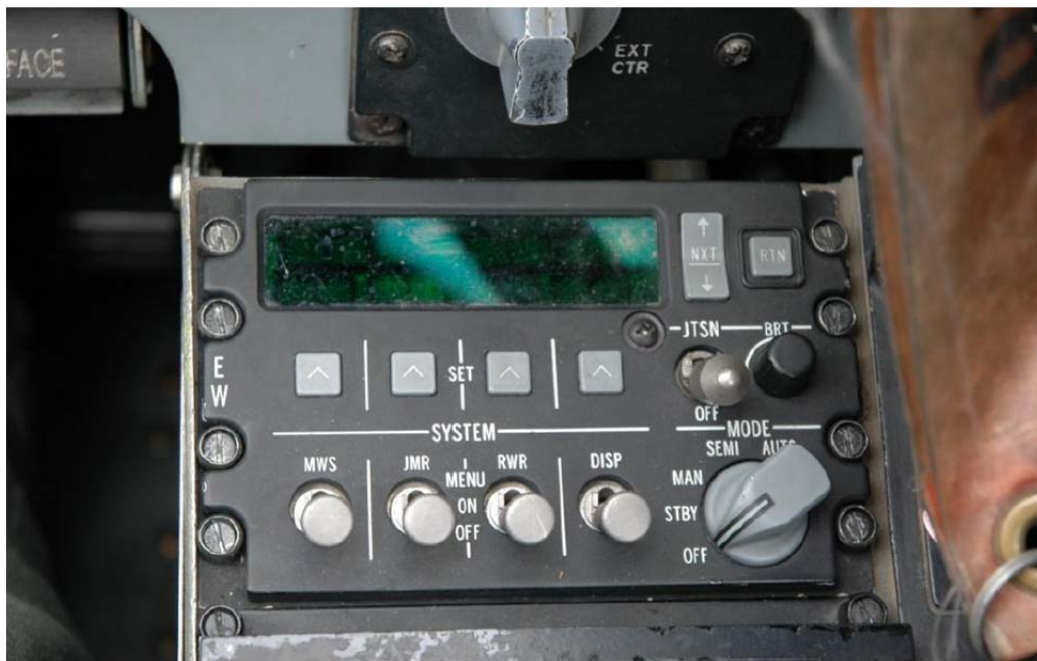
图-39.反措施对抗信号处理器面板
