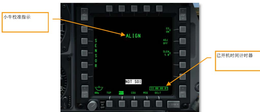
图 454.DSMS 小牛页面，校准
