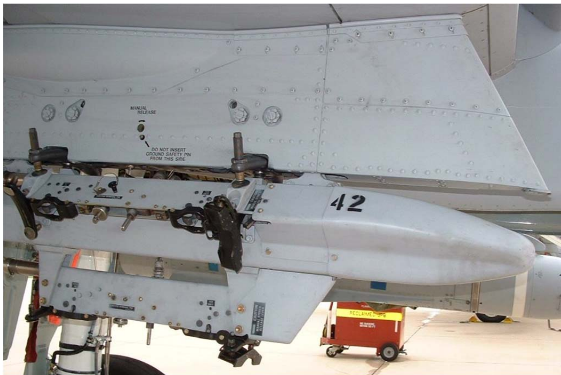
图-43 BRU-42 三联弹射挂架
