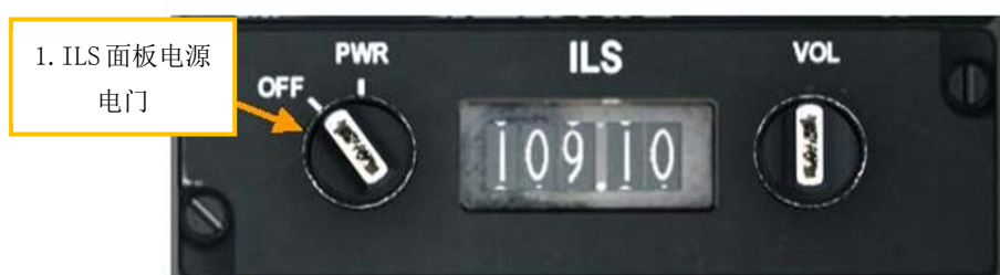
图 305 仪表着陆系统控制面板
