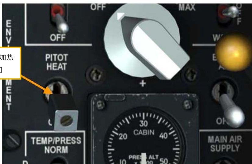
图 319 测试空速管加热
