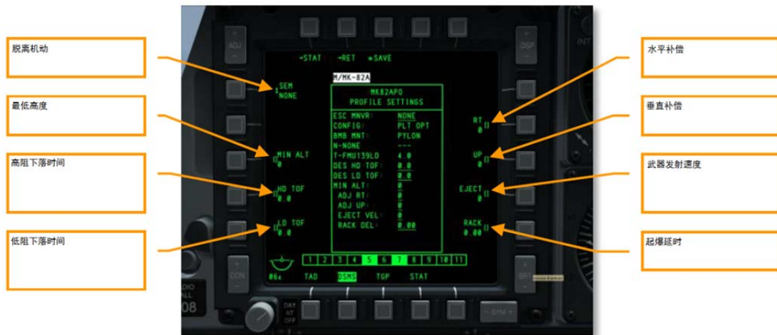
图 422.DSMS 数据操控页面，高阻非制导炸弹
