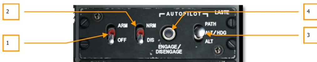
图 109, LASTE 控制面板
