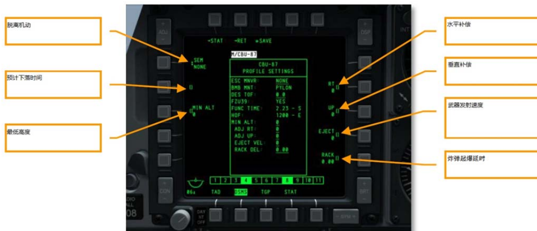
图 420.DSMS 数据操控页面，非制导炸弹
