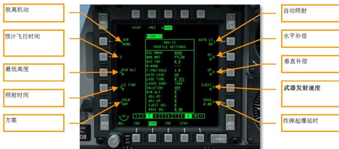
图 442.DSMS 文档设置页面，激光制导炸弹
