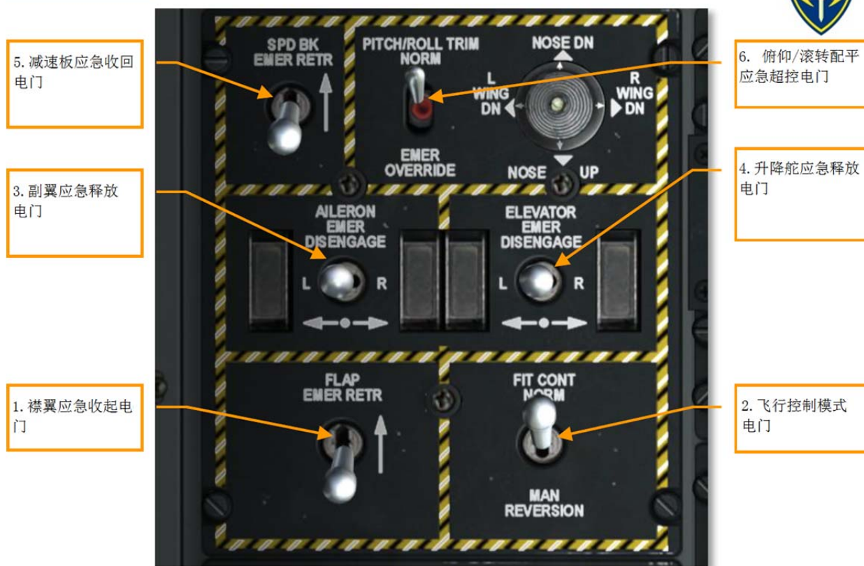
图296 应急飞行控制面板
