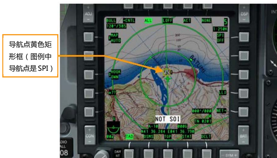
图349 TAD上的导航点符号
