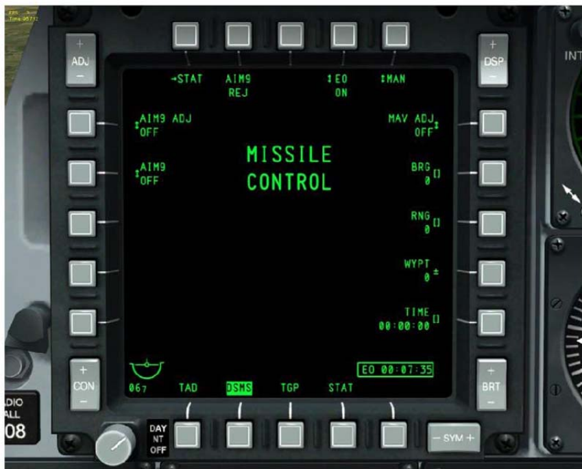
图224 DSMS 导弹控制页面
