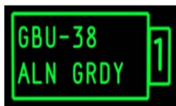
图 447.GBU-38 挂点状态方框，飞机停在地面
