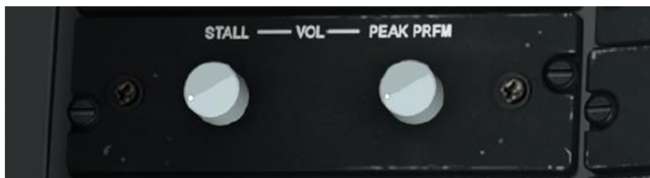
图 121.失速告警控制面板
